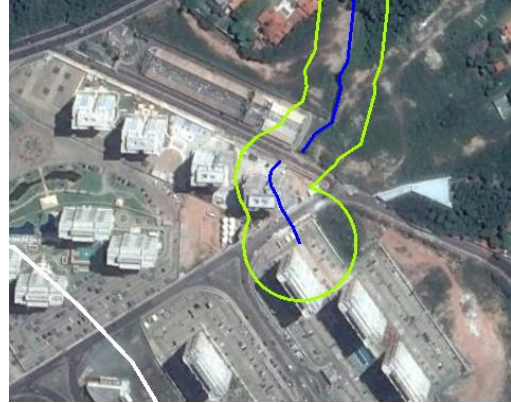
Figura 40 – Conflito entre APP e a Ocupação (R03). Fonte: Google Earth, 2015.
