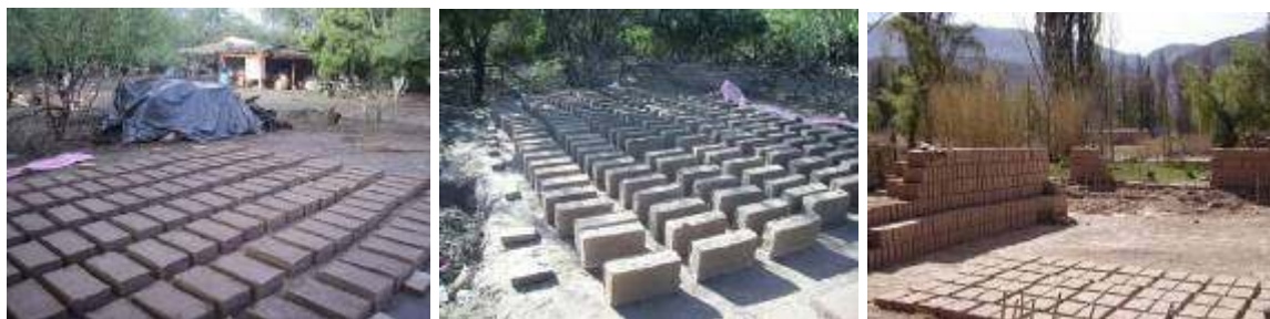
Figura 7 – Etapas de secagem e armazenamento de adobes
