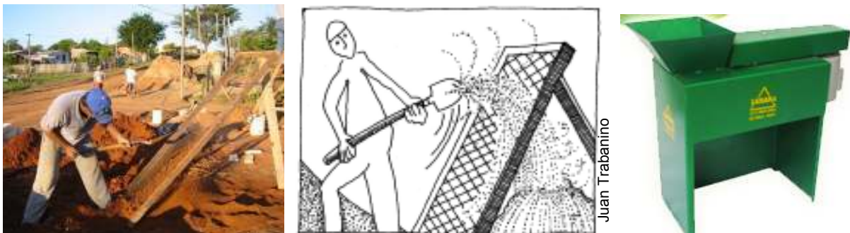
Figura 2 – Peneiramento manual da terra e um modelo de destorroador mecânico
