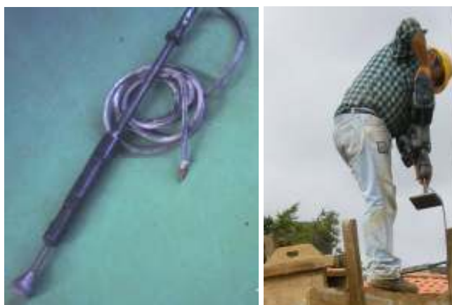
Figura 13 – Exemplos de compactador mecânico. Esquerda: compactador pneumático de agulha. Direita: compactador elétrico de placa vibratória
