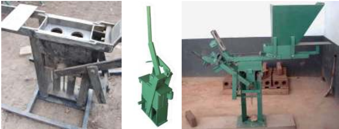
Figura 10 – Prensa Mattone (à esquerda) e mais dois modelos de prensas manuais
