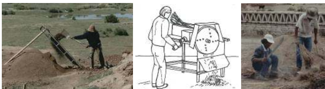
Figura 3 – Peneiramento da terra; trituração mecânica e corte manual das fibras vegetais
