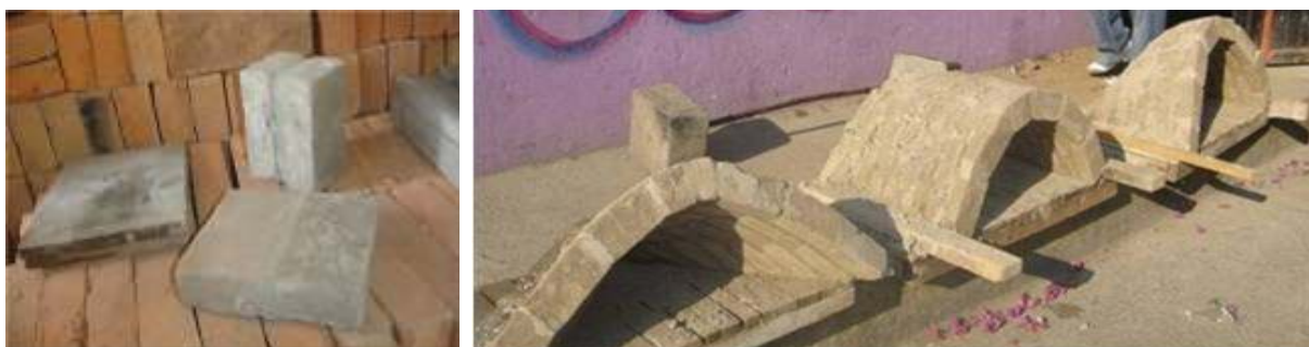
Figura 16 – Teste de aderência e amostras de diferentes tipos de abóbadas
