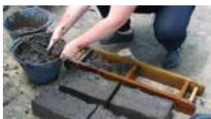
Molde Construcción con terrabaires
