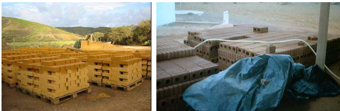
Figura 6 – Armazenamento dos BTC
