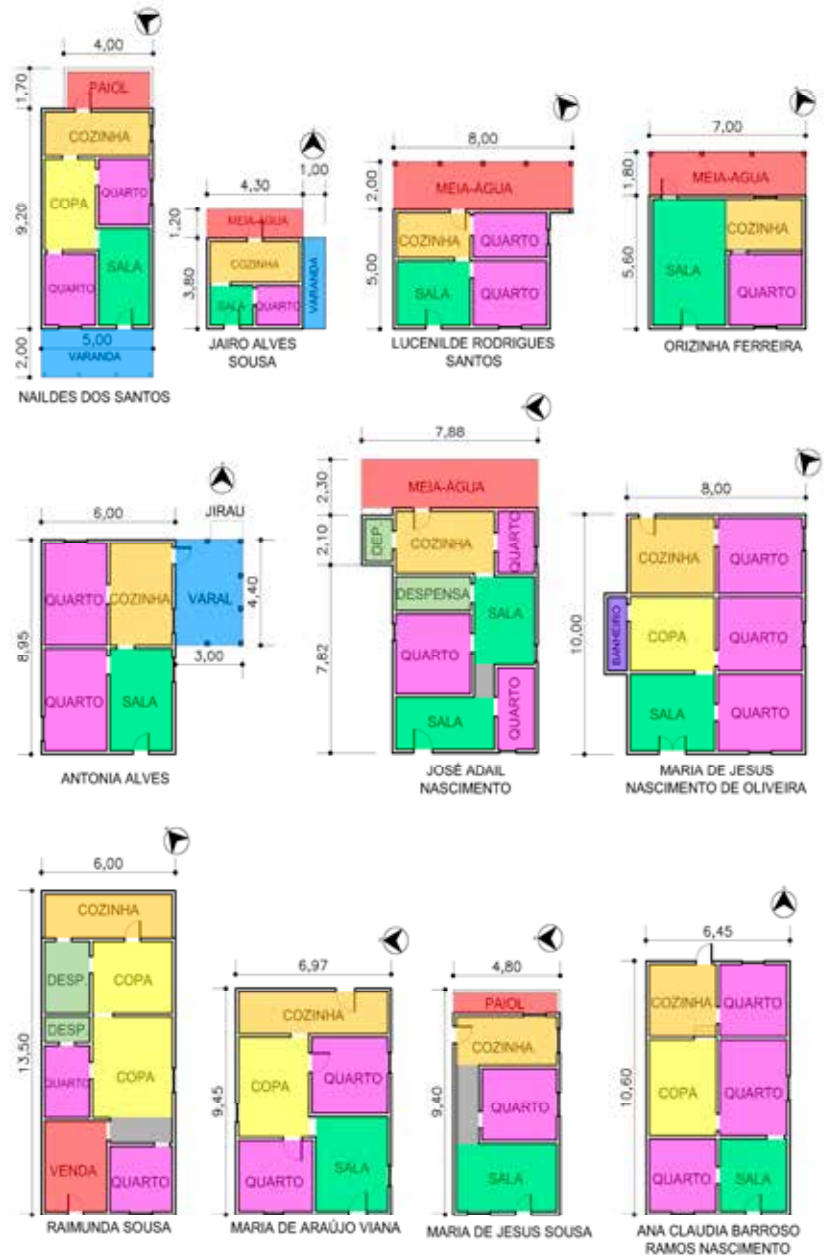
Figura 5 - Tipos de plantas baixas de moradias em Pequizeiro, Belágua.
